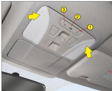
Для включения переднего плафона освещения салона нажать на заднюю часть плафона, при этом соответствующая лампа для чтения дорожной карты загорается.
