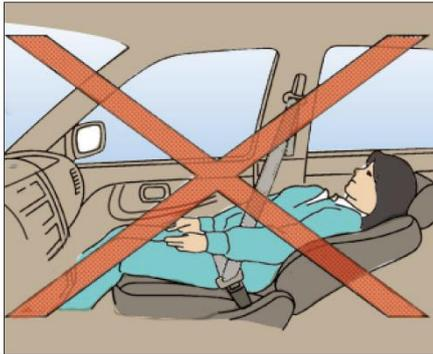
Во время движения автомобиля не следует чрезмерно наклонять спинку сиденья для получения комфорта, это очень опасно. В противном случае верхний отрезок ремня безопасности не прилегает к телу пассажира и не может выполнять защитное действие. При возникновении непредвиденных обстоятельств мощная инерционная сила может привести к серьезной травме пассажиров.
