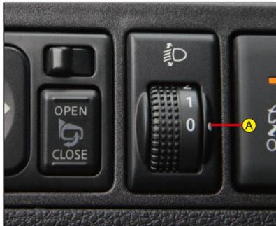
При нахождении выключателя зажигания или кнопки старт-стоп в положении "ON" и при горении передних фар, водитель может повернуть ручной маховик для регулировки передних фар.
