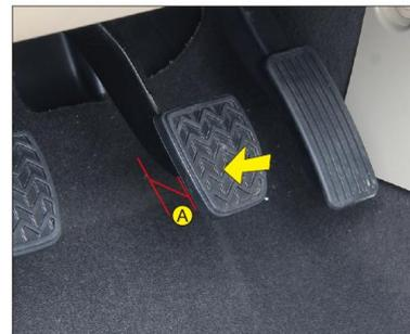
При работающем двигателе проверить расстояние
