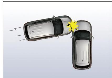
При боковом ударе об отсек двигателя или багажник, если ударная энергия, полученная системой подушки безопасности, не достаточна для раскрытия подушки безопасности, то раскрытие фронтальной и боковой подушек безопасности и боковой шторки безопасности не происходит.
