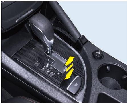
Типтроник оснащен электронным стояночным тормозом, именуемым EPB.
