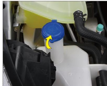
Для лучшей очистки можно добавить омывающую жидкость в резервуар омывающей жидкости.
