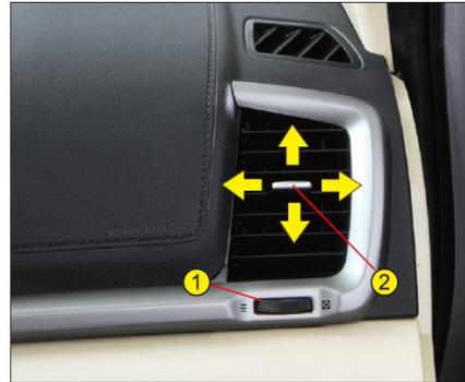
Перемещением ролика ① можно открыть/закрыть вентиляционное отверстие.
