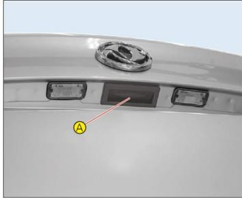
Имея при себе интеллектуальный ключ, нажать на выключатель запроса (A) на двери задка, поднять вверх дверь задка, чтобы открыть ее.
