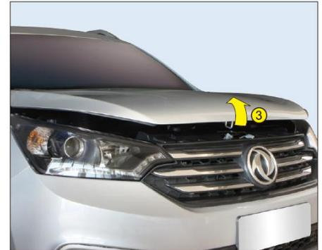
Поднять вверх капот ③ двигателя.
