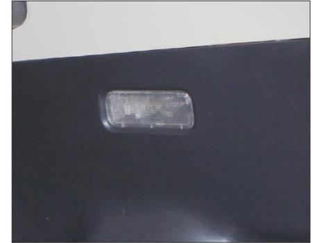
При открытии двери задка лампа освещения багажника загорается. При закрытии двери задка данная лампа гаснет. Система экономии электроэнергии внутреннего освещения
