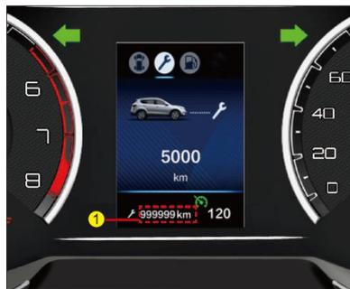
① **Общий пробег:** общий пробег после выпуска автомобиля с завода. Диапазон общего пробега: 0-999999 км.
