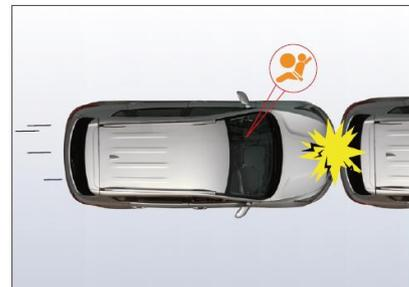
Если подушка безопасности не была своевременно отремонтирована после срабатывания сигнализатора неисправной системы подушки безопасности, то при возникновении столкновении фронтальная и боковая подушки безопасности и боковые шторки безопасности не могут раскрыться.
