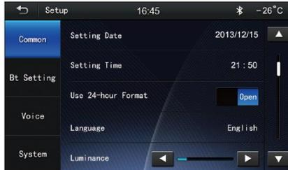
Предметы общей настройки включают в себя настройку даты, времени, 24-часовой формы, языка, яркости экрана, часового режима ожидания, изменения темы. В интерфейсе общей настройки можно установить дату, время и форму времени, язык, яркость экрана, часовой режим ожидания и тему.
