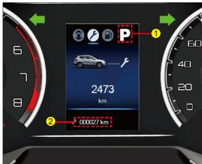
① **Информация о передачах:** текущие передачи, при которых двигается автомобиль: "P", "R", "N", "D", "1", "2", "3", "4", "5" или "6".
