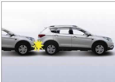
При столкновении автомобиля с автомобилем, движущимся сзади, может не происходить раскрытие фронтальной и боковой подушек безопасности и боковой шторки безопасности
