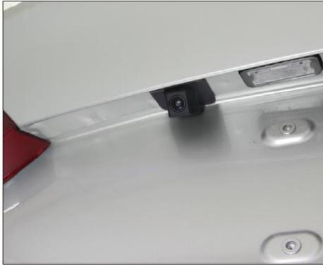
При перемещении рычага переключения передач в положение “R” (передача заднего хода) сенсорный ЖК-экран автоматически переключается на изображение задней части автомобиля.
