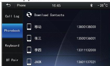
При нажатии на "Download Contacts" происходит синхронизация "контактов" телефона с информационно-развлекательным оборудованием в автомобиле.
