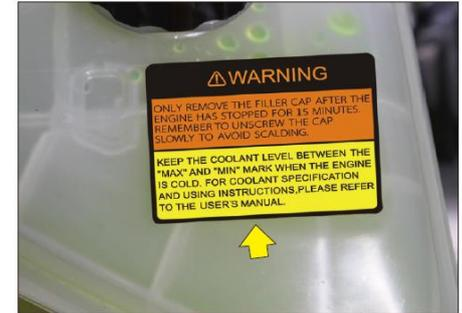
Она приклеена над резервуаром охлаждающей жидкости.
