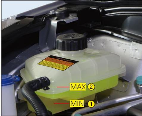
После охлаждения двигателя проверить уровень охлаждающей жидкости. Если уровень охлаждающей жидкости находится ниже отметки MIN **1**, добавить охлаждающую жидкость до положения отметки MAX **2**.
