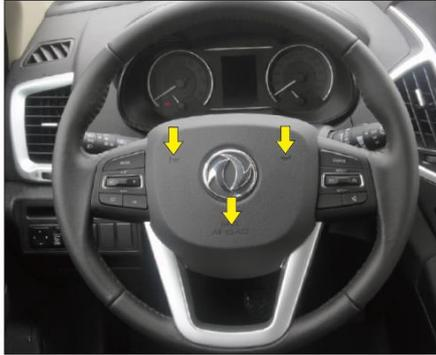
При нажатии на любой из выключателей звукового сигнала в трех местах, как показано на рисунке, и при удержании его нажатым, звуковой сигнал выдает звук. При отпускании выключателя прекращает выдавать звук.
