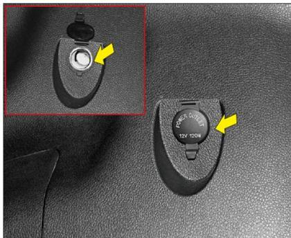
Розетка электропитания 12 В расположена на правой стороне внутри багажника или в месте центральной вспомогательной панели приборов\*. При нахождении выключателя зажигания или кнопки старт-стоп в положении ACC или ON открыть крышку розетки электропитания для ее использования.
