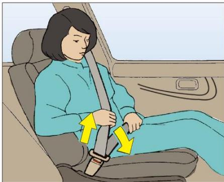
Сначала проследить за тем, чтобы нижняя секция ремня безопасности по возможности проходила через тазовую область, а затем вытянуть вверх верхнюю секцию ремня безопасности, чтобы нижняя секция ремня прилегла к телу. Таким образом, тазовые кости могут выдержать сильный удар, что уменьшает вероятность внутренних повреждений.
