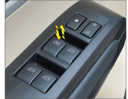
Водительское окно обладает функцией автоматического поднятия/опускания и защиты от заземления.
