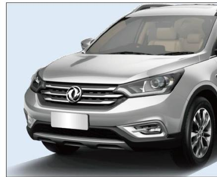
При нахождении выключателя зажигания в положении "ON" двигатель работает, дневные ходовые огни загораются, что повышает безопасность вождения и демонстрирует модные веяния. При прекращении работы двигателя или при включении габаритных огней дневные ходовые огни гаснут.
