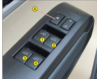
Выключатель стеклоподъемника двери водителя, то есть главный выключатель, может управлять открытием и закрытием всех окон.
