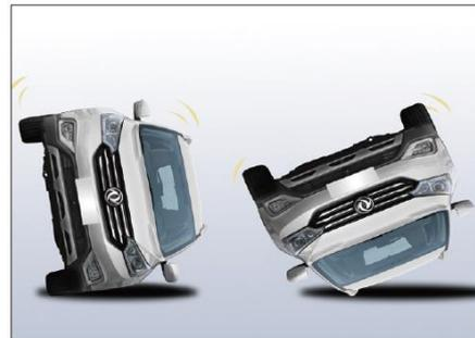
При опрокидывании автомобиля даже раскрытие фронтальной подушки безопасности не может обеспечить соответствующую защиту. Но боковые подушки безопасности и боковые шторки безопасности могут раскрыться при боковом столкновении и опрокидывании автомобиля.
