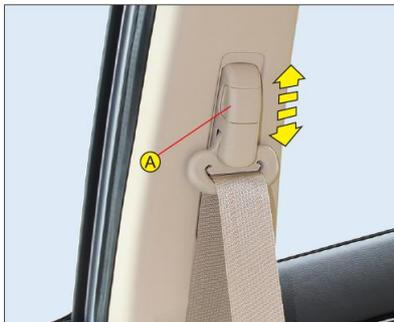
Потянуть кнопку **A** блокировки, переместить вверх и вниз регулятор высоты до подходящего положения, отпустить и слегка покачать вверх и вниз, чтобы убедиться в блокировке регулятора.
