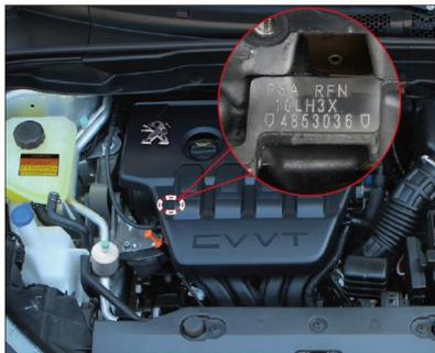
Порядковый номер двигателя выбит на корпусе цилиндра каждого двигателя. Данный номер является уникальным.
