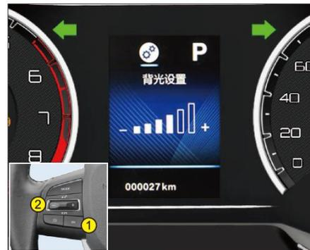
В интерфейсе "Настройка меню" выбрать меню "Настройка подсветки". Краткое нажатие на кнопку "OK" ① управления комбинацией приборов на рулевом колесе позволяет войти в интерфейс "Настройка подсветки". При перемещении вверх или вниз выключателя управления ② происходит регулирование подсветки приборов. После завершения регулировки кратко нажать на кнопку "OK" ① для подтверждения настройки.
