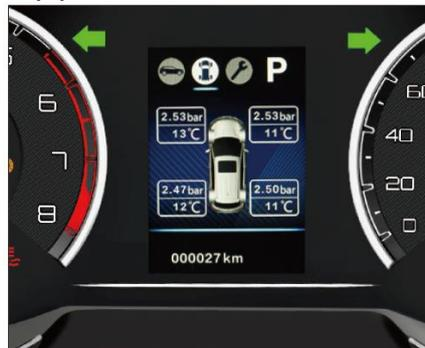
После входа в интерфейс информации о давлении в шинах можно просмотреть состояние давления в шинах.
