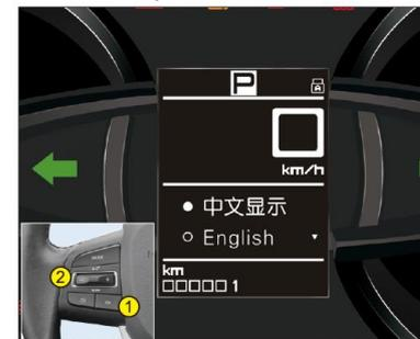
В интерфейсе "Настройка системы" выбрать меню "Языковая настройка". Краткое нажатие на кнопку "OK" **1** управления комбинацией приборов на рулевом колесе позволяет войти в интерфейс "Языковая настройка". При перемещении вверх или вниз выключателя управления **2** происходит циклическое переключение между меню "Китайский язык", "English" и "Возврат". После завершения регулировки кратко нажать на кнопку "OK" **1** для подтверждения настройки.
