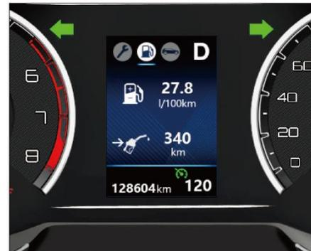
Комбинированный дисплей показывает соответствующую информацию о движении автомобиля. При помощи кнопки управления приборами на рулевом колесе можно провести языковую настройку, установку яркости, многофункциональную настройку и напоминание о переключении передач\*.
