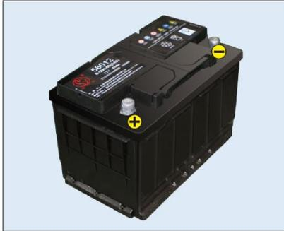
Напряжение аккумуляторной батареи, используемой в данном автомобиле, составляет 12 В с перемычкой отрицательного полюса. При снятии аккумуляторной батареи необходимо сначала отсоединить отрицательный полюс аккумуляторной батареи, затем отсоединить положительный полюс аккумуляторной батареи. При установке аккумуляторной батареи необходимо сначала соединить положительный полюс аккумуляторной батареи, затем соединить отрицательный полюс аккумуляторной батареи.
