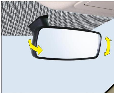
Держась за внутреннее зеркало заднего вида, можно в направлении стрелок на рисунке, соответственно отрегулировать углы зеркала заднего вида в 4 направлениях до подходящего положения.
