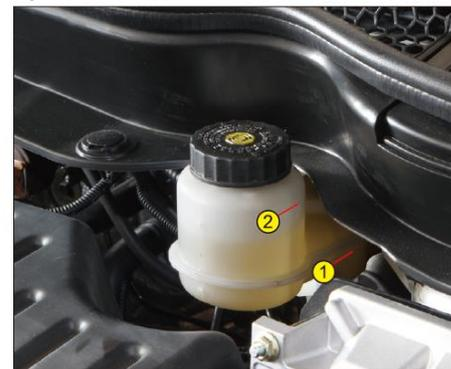
Проверить уровень тормозной жидкости в резервуаре. При уровне тормозной жидкости ниже отметки MIN ①, загорается сигнализатор тормозной системы. Добавить тормозную жидкость до отметки MAX ②. При необходимости частой добавки тормозной жидкости следует обратиться в дилерский сервисный центр для проверки системы (подробную информацию о рекомендуемом типе тормозной жидкости см. стр. P7-5).
