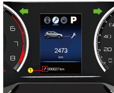
Для информации о техническом обслуживании показывается пробег до следующего технического обслуживания.
