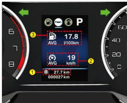
① **Пробег:** общий пробег для суточного пробега В.
