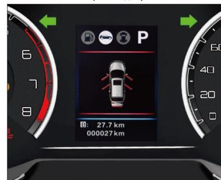
Напоминание о незакрытых дверях указывает на состояние открытия и закрытия всех дверей и двери задка. При открытии какой-либо двери или нескольких дверей на дисплее комбинации приборов показывается состояние незакрытых дверей (на верхнем рисунке показано состояние всех незакрытых дверей и двери задка).
