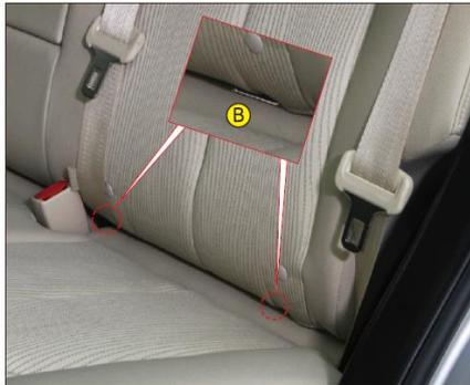
Данный автомобиль оборудован двумя группами механизмов блокировки детского безопасного автокресла ISOFIX, каждая группа устройства включает в себя 1 верхнее анкерное крепление (A) и 2 нижних анкерных крепления (B).
