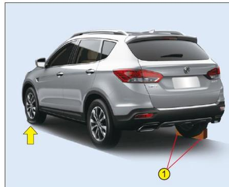
Подложить соответствующие упоры <sup>1</sup> спереди и сзади колеса, расположенного по диагонали от неисправного колеса (разрыв, прокол, выступ, утечка воздуха), с целью предотвращения перемещения автомобиля при его поднятии.
