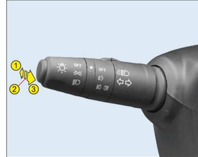
Для включения фар дальнего света следует переместить рычаг в положение 1 при включенных фарах ближнего света.
