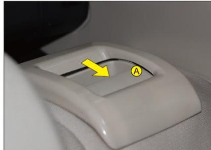
3. Пальцами нажать на блокирующий элемент A через внутреннюю часть блокирующего устройства над спинкой (в направлении, указанным стрелкой на рисунке), одновременно с этим потянуть спинку сиденья в направлении к передней части автомобиля.
