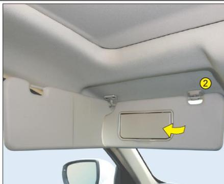
Для защиты от яркого света сбоку отсоединить солнцезащитный козырек от промежуточного кронштейна **2** и повернуть в боковую сторону.
