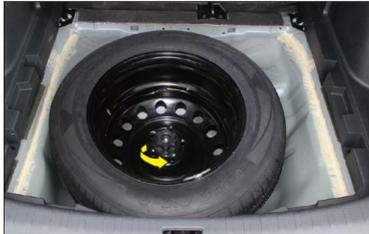
Извлеките подкладку **A** ЗИП и запасное колесо из зоны для хранения под ковром багажника.
