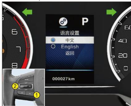
В интерфейсе “Настройка меню” выбрать меню “Языковая настройка”. Краткое нажатие на кнопку “OK” ① управления комбинацией приборов на рулевом колесе позволяет войти в интерфейс “Языковая настройка”. При перемещении вверх или вниз выключателя управления ② происходит циклическое переключение между меню “Китайский язык”, “English” и “Возврат”. После завершения регулировки кратко нажать на кнопку “OK” ① для подтверждения настройки.
