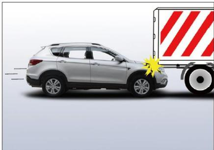
При столкновении автомобиля с крупным автомобилем передняя часть автомобиля может проникнуть под нижнюю часть грузовика из-за большого дорожного просвета, при этом ударная энергия поглощается в результате серьезной деформации передней части автомобиля. Если датчик подушки безопасности обнаружит, что отрицательное ускорение недостаточно для раскрытия подушек безопасности, то не происходит раскрытия фронтальной и боковой подушек безопасности и боковой шторки безопасности.
