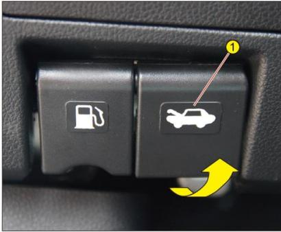
Потянуть рычаг ① открытия капота двигателя в левой нижней части панели приборов, чтобы капот двигателя приоткрылся.
