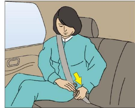
Медленно вытянуть ремень безопасности из втягивающего устройства, затем вставить язычок в пряжку ремня, что сопровождается “щелчком”, затем обратно потянуть ремень безопасности, чтобы убедиться в надежной фиксации.
