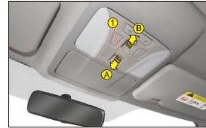
Открытие/закрытие люка крыши осуществляется только при нахождении выключателя зажигания или кнопки start-stop в положении "ON".
