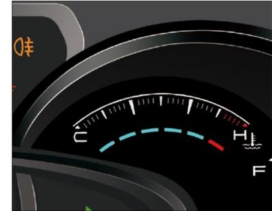
При включении зажигания индикатор под шкалой температуры указывает на температуру охлаждающей жидкости двигателя.
