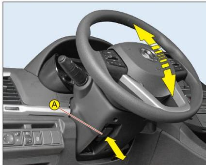
Отпустить рычаг A блокировки рулевого колеса, отрегулировать положение рулевого колеса в вертикальном направлении, чтобы обеспечить комфорт и безопасность вождения людьми с разным телосложением. После регулировки переместить обратно рычаг A блокировки, чтобы убедиться в блокировке положения рулевого колеса.
