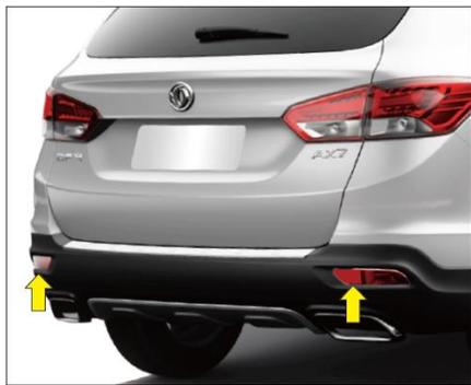
Отражатели предназначены для отражения света движущихся позади автомобилей, чтобы предупредить водителей движущихся позади автомобилей о соблюдении безопасного расстояния. Следует поддерживать чистоту поверхности отражателей. При повреждении отражателя необходимо своевременно обратиться в дилерский сервисный центр для замены, чтобы гарантировать безопасность движения.
