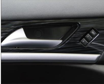
Данная функция позволяет сохранить в памяти предварительно установленный угол автоматического опускания левого и правого наружных зеркал заднего вида вниз, что оказывает помощь водителю в быстром осмотре наземной ситуации при движении задним ходом с помощью наружных зеркал заднего вида.
