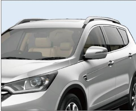
Для обеспечения Вашей безопасности и защиты крыши автомобиля от повреждения следует использовать рейлинги на крыше автомобиля. Перед размещением предметов (например, велосипедная полка, полка для лыж и т.д.) на рейлинги необходимо дополнительно установить крепежные поперечные стержни и закрепить к ним перевозимые предметы, а также убедиться в полном открытии или закрытии люка крыши. Запрещается вешать или связывать перевозимые предметы вне рейлингов на крыше автомобиля.
