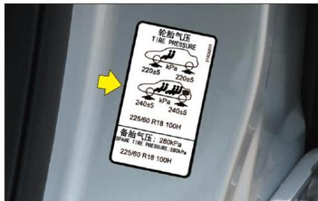
Табличка с информацией о шинах, приклеенная на промежуточной стойке на стороне водителя, описывает давление в шинах в холодном состоянии, спецификацию шины и т.д.
