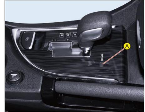
Если при истощении заряда аккумуляторной батареи и при нажатии на педаль рабочего тормоза рычаг переключения передач не может выдвигаться из стояночного положения "Р", то можно нажать до упора
