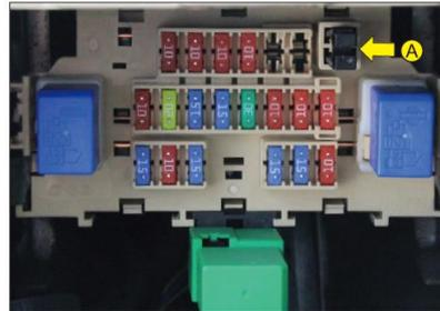
Снять накладку **1** в левой нижней части панели приборов, таким образом можно увидеть коробку предохранителей в салоне.
