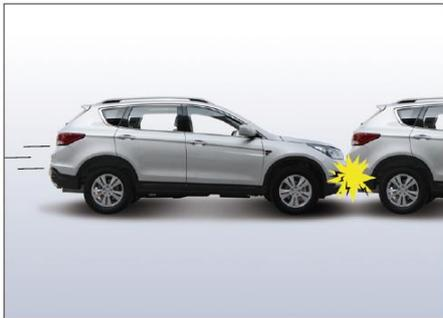
При наезде на движущийся впереди автомобиль, если ударная энергия, полученная системой подушки безопасности, не достаточна для раскрытия подушки безопасности, то раскрытие фронтальной и боковой подушек безопасности и боковой шторки безопасности не происходит.
