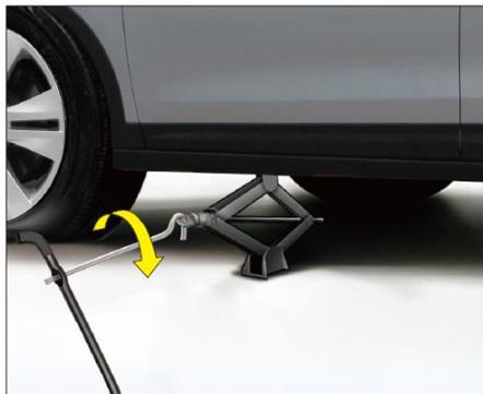
1. Подложить домкрат прямо под точку опоры кузова, приближенную к неисправному колесу. Повернуть болт домкрата, чтобы выемка в верхней части домкрата совпала с точкой опоры кузова, но не следует поднимать автомобиль.
