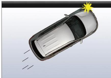
При столкновении автомобиля по касательной с дорожным ограждением или с другими автомобилями, если ударная энергия, полученная системой подушки безопасности, не достаточна для раскрытия подушки безопасности, то не происходит раскрытие фронтальной и боковой подушек безопасности и боковой шторки безопасности.
