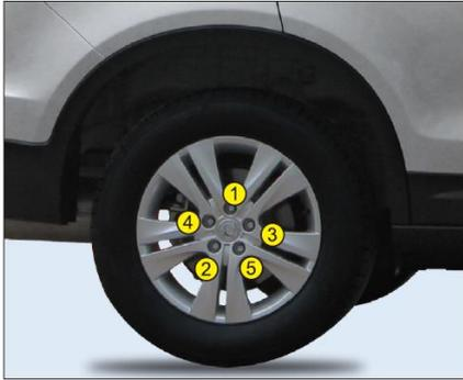
1. Удалить глину или грязь с поверхности между колесом и ступицей;
