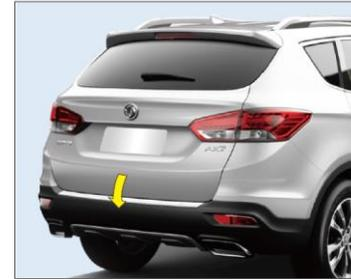
Для закрытия двери задка нажать вниз на дверь до надежной блокировки.
