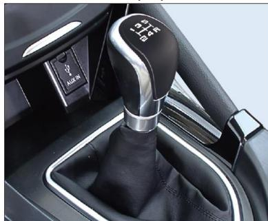
Механическая КПП имеет 5 передач переднего хода и 1 передачу заднего хода. Полное нажатие на сцепление позволяет переключать передачи по ступеням.
