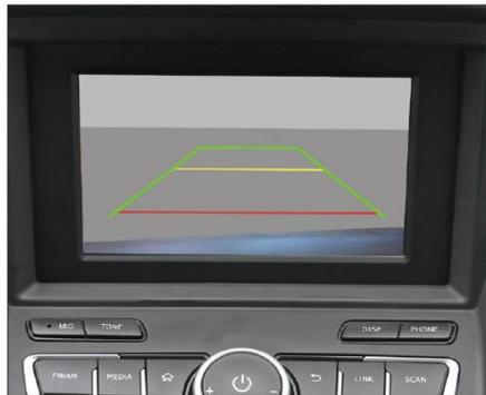
При перемещении рычага переключения передач в положение "R" (передача заднего хода) сенсорный ЖК-дисплей автоматически переключается в изображение задней части автомобиля.
