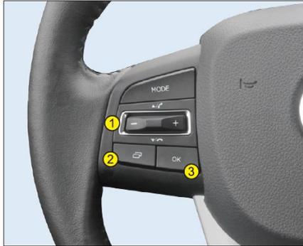
Нажатием на кнопку **2** перелистывания страниц “” выполняется переключение показания разной информации о движении автомобиля. В интерфейсе фоновой настройки нажатием на данную кнопку можно вернуться в главный интерфейс.
