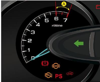
Тахометр показывает обороты двигателя в минуту. Обороты двигателя: значение стрелки  $\times 1000$  об/мин.
