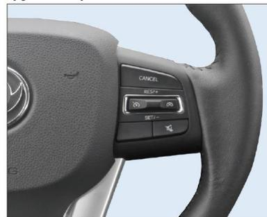
Водитель может удобно активизировать/выключить функцию круиз-контроля с помощью кнопки управления на рулевом колесе.
