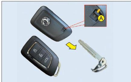
Передвинуть замычку **A** интеллектуального ключа в направлении стрелки, таким образом можно вынуть механический ключ.
