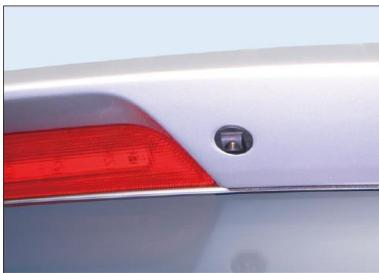
При наличии посторонних предметов вокруг форсунки омывателя следует временно удалить их, в противном случае это может влиять на нормальную работу омывателя ветрового стекла.
