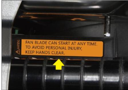
Она приклеена на ветрозащитном кожухе вентилятора.
