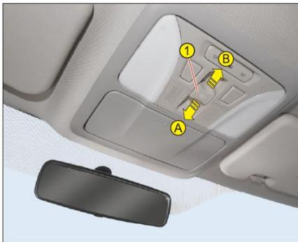
При нахождении выключателя зажигания или кнопки «старт-стоп» в положении «ON» можно открыть или закрыть люк крыши.
