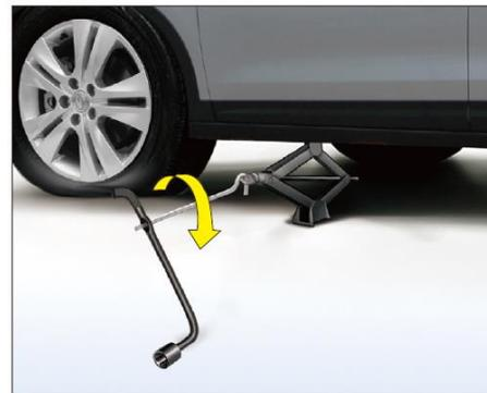
1. Снять колесные болты.
