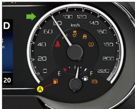
При нахождении выключателя зажигания или кнопки старт-стоп в положении "ON", на данном приборе показывается примерный объем оставшегося топлива в баке.
