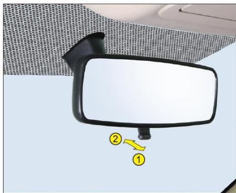
При движении в ночное время, если свет едущего позади автомобиля слепит водителя, можно потянуть регулировочный рычаг в направлении стрелки ①, чтобы избежать слепящего света.
