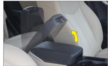
Верхняя крышка ящика объединяет в себе функцию центрального подлокотника. Держась за переднюю часть верхней крышки ящика, потянуть ее в направлении к передней части автомобиля, при этом крышка ящика может вытягиваться и превращаться в центральный подлокотник. Держась за переднюю часть верхней крышки ящика, можно поднять вверх примерно на 90°.
