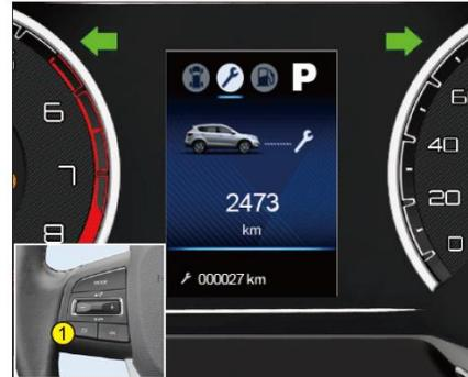
При нахождении выключателя зажигания или кнопки старт-стоп в положении “ON” автоматически показывается информация об автомобиле, включая информацию о передачах\*, общий пробег.
