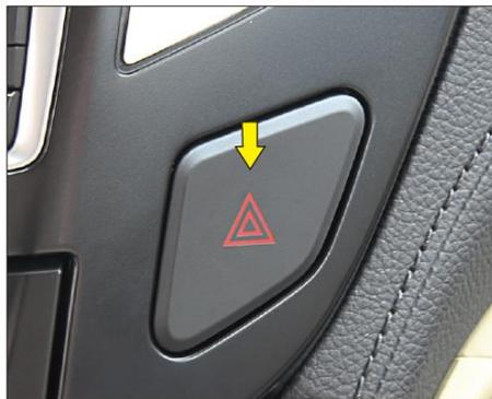
При нажатии на данный выключатель фонари указателей поворота и индикаторы поворота мигают. При повторном нажатии сигнализация снимается.
