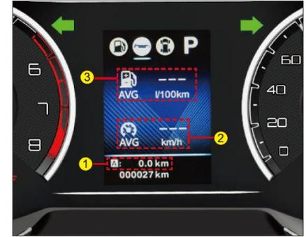
① **Пробег:** общий пробег для суточного пробега А.
