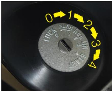
Вставить ключ в отверстие замка выключателя зажигания и повернуть ключ до требуемого положения.
