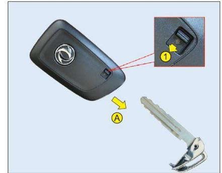
При необходимости извлечь механический ключ из интеллектуального ключа, сначала слегка переместить кнопку ① блокировки в сторону, указанную стрелкой и удерживать ее, затем осторожно извлечь механический ключ из интеллектуального ключа в направлении Ⓐ, указанном на рисунке.
