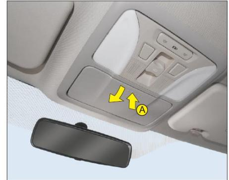
Для открытия очечника следует слегка нажать на выступ **A**, при этом очечник автоматически выскакивает вниз. Для его закрытия толкнуть крышку до запираения.
