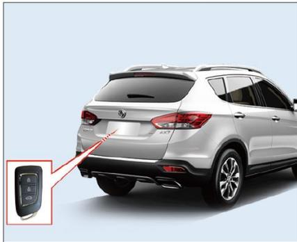
Для предотвращения случайного запирания интеллектуального ключа в багажнике, интеллектуальный ключ оснащен функцией защиты от запирания. Если интеллектуальный ключ был оставлен в автомобиле (в том числе в багажнике) во время закрытия двери задка при запертых всех дверях, то зуммер выдает звук, к тому же двери отпираются.
