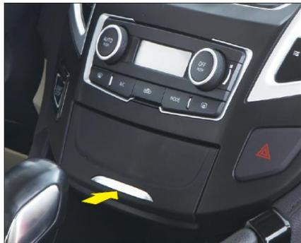
Для открытия центрального вещевого ящика на панели приборов следует нажать на середину нижнего края вещевого ящика, при этом крышка ящика автоматически открывается вверх. Для его закрытия толкнуть вниз крышку до заперения.
