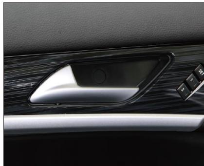
При запортом центральном замке однократное потягивание внутренней ручки двери водителя позволяет отпереть все двери. В это время потянуть внутреннюю ручку соответствующей двери для ее открытия.
