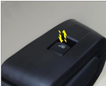
Выключатель стеклоподъемников пассажирских дверей может управлять соответствующим окном. При нажатии на кнопку блокировки пассажирских окон на выключателе на стороне водителя функция поднятия/опускания пассажирских окон не действует.
