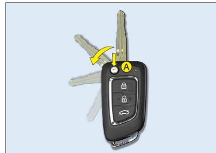
Сначала нажать на кнопку **A**, затем сложить ключ. При складывании ключа, если не нажимать на данную кнопку, может возникнуть повреждение внутреннего механизма.
