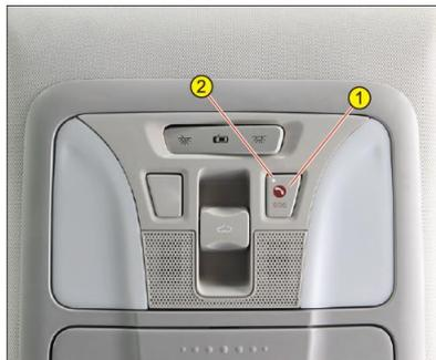
Кнопка **1** функции экстренной помощи расположена на панели управления люком крыши. Данная функция может быть включена в следующих случаях:
