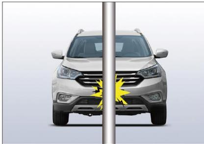
При столкновении автомобиля с тонкими предметами, такими как электролиния, дерево и т.д. точка столкновения концентрирована на одном месте, ударная энергия поглощается в результате серьезной деформации автомобиля, что ударное усилие не было полностью передано в датчик подушки безопасности. При этом не происходит раскрытие фронтальной и боковой подушек безопасности и боковой шторки безопасности.
