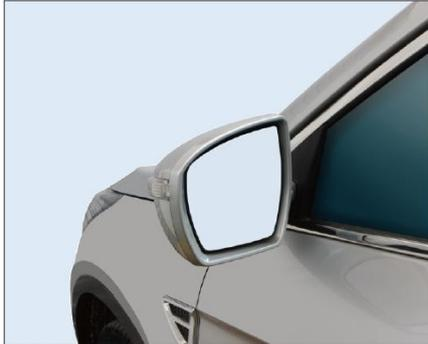
При движении задним ходом данная функция позволяет левому или правому зеркалу заднего вида автоматически опуститься вниз, что обеспечивает лучший обзор задней части автомобиля.
