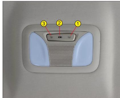
Задний плафон освещения салона (внутренняя лампа) имеет один трехпозиционный выключатель.
