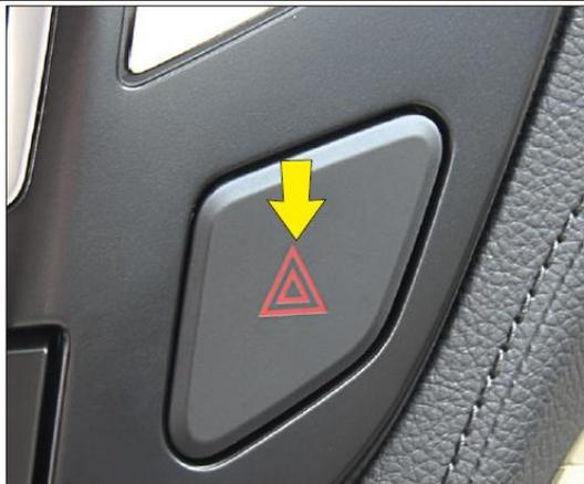
При необходимости выдачи аварийного сигнала нажать на выключатель лампы аварийной сигнализации, при этом будут мигать все фонари указателей поворота. Для снятия аварийной сигнализации повторно нажать на выключатель лампы аварийной сигнализации, при этом все фонари указателей поворота гаснут.
